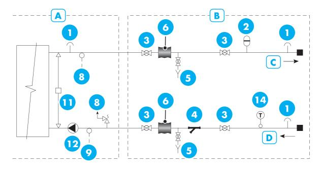
DHW side hydraulic connections
